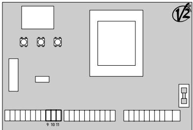
جهت رعایت قوانین EN 12978، نصب نبش های حفاظتی کنترل شده توسط واحد کنترل ضروری است، تا به طور مستمر کارکرد مناسب مربوط را چک کند. اگر از واحدهای کنترل مناسب جهت تست توان خروجی استفاده می کنید، سیم های منبع تعذیه واحد کنترل را بین ترمینالهای ۱۹ و ۱۸ واحد کنترلی City1 وصل کنید در غیر این صورت سیم های منبع تعذیه را بین ترمینالهای ۱۷ و ۱۸ وصل کنید.
