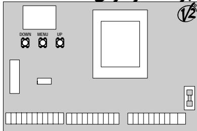
برنامه دار کردن زمان و عملکرد واحد کنترل از طریق یک منوی وضعیت انجام می‌شود که در دسترس شماست و شما می‌توانید از طریق کلیدهای Up و Down و Menu آن را روی صفحه نمایش قرار دهید.
