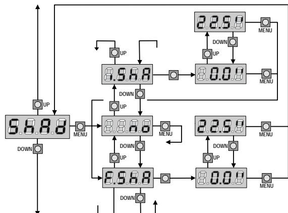
حرکت درب، زمانی که فتوسلها فعال نیستند، در عرض چند ثانیه ابتدایی بسته شدن درب اندازه گرفته می شود و از مکریزم مکان باز شدن شروع می شود. لطفاً مراحل زیر را جهت نصب حدود منطقه سایه دار دنبال کنید.
