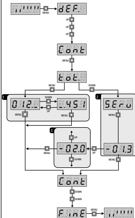
ناحیه ۱، محل خواندن تعداد کل دفعات باز یا بسته شدن درب است. از طریق کلیدهای Up, Down, MENU می توانید نمایش واحدها یا هزارها را یک در میان کنید.
