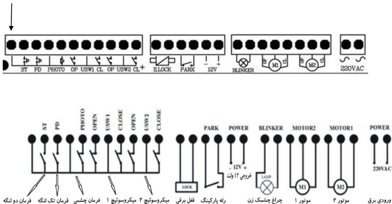
موتور 1 و موتور 2 از نوع 220 ولت میباشند.
